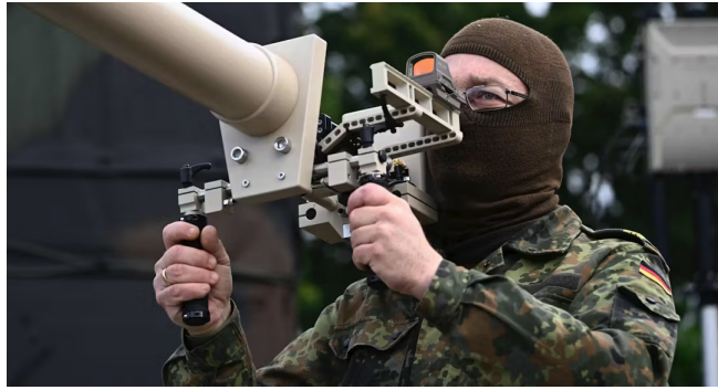
Ein Bundeswehrsoldat nutzt bei der Übung „Red Storm Bravo“ in Hamburg einen tragbaren Drohnenstörsender vom Typ HP 47 neben einem RADIS-Funkaufklärungssystem. Tobias Schwarz/AFP
