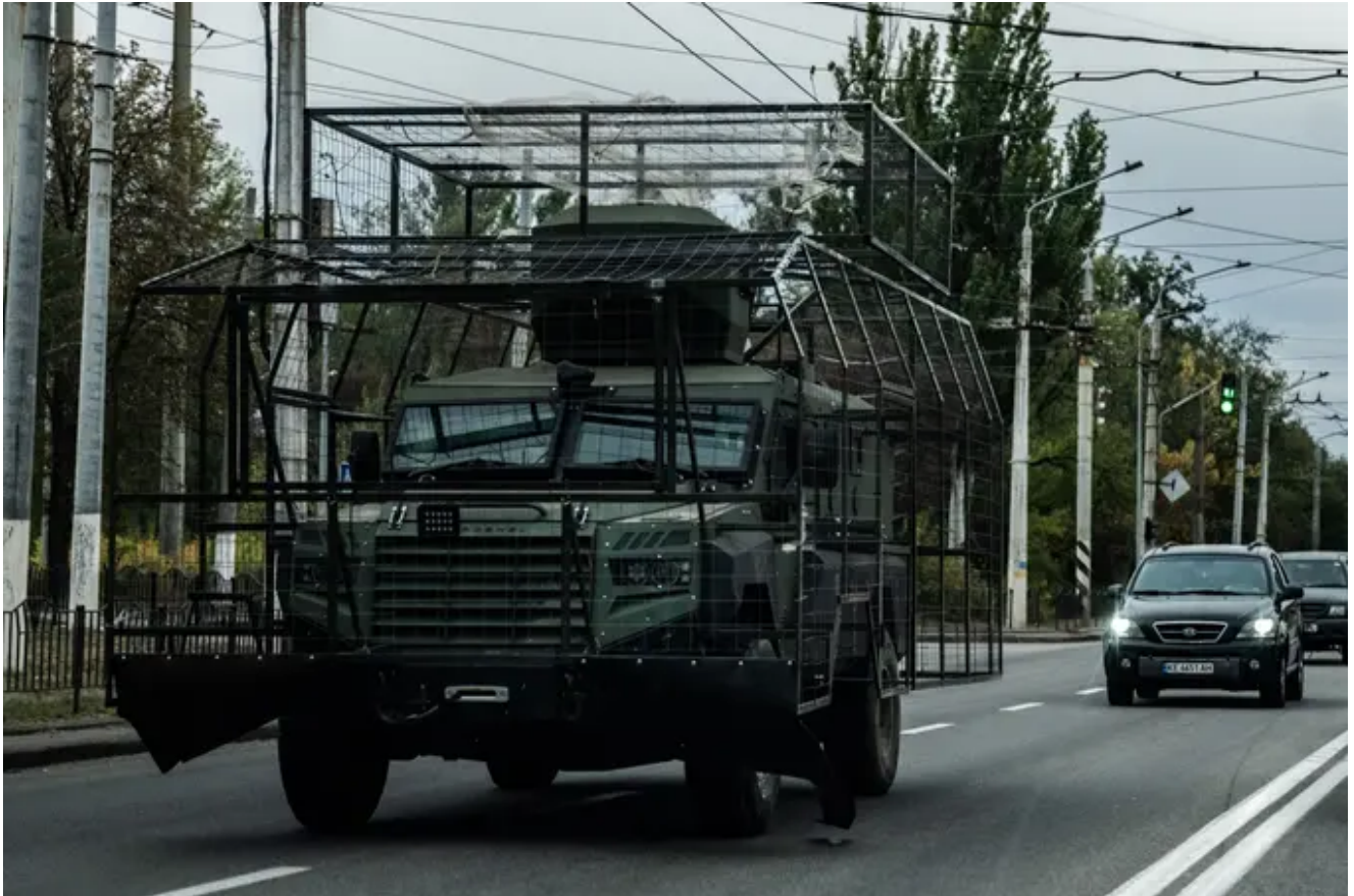
Ein Stahlkäfig soll dieses Militärfahrzeug vor Drohnenangriffen schützen.
